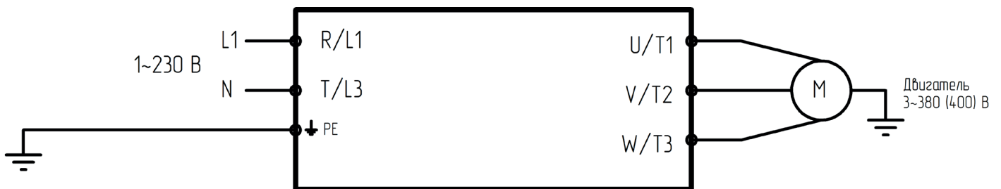
Подключение силовых клемм для моделей LCI-GY/PY-3
