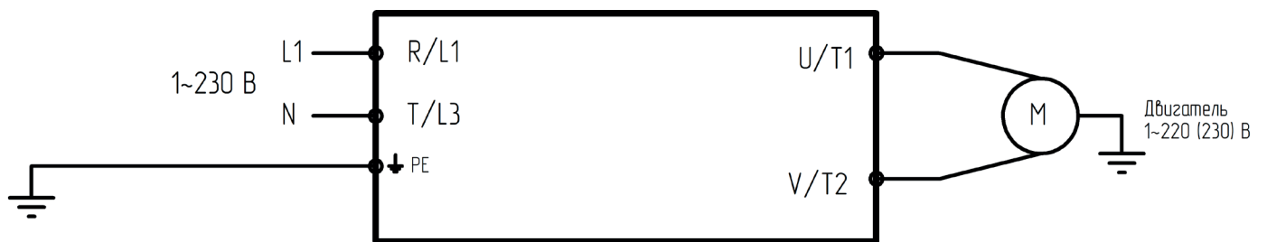
Подключение силовых клемм для моделей LCI-GY/PY-1
